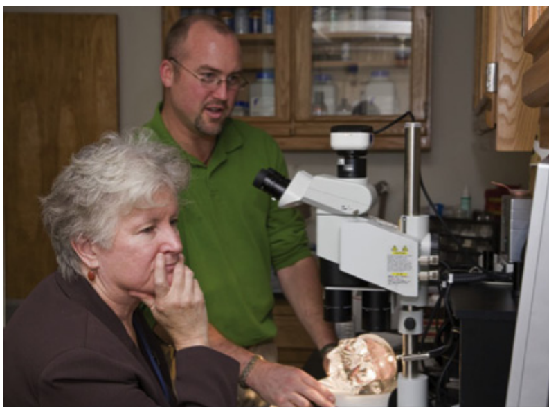
La autora y Scott Whittaker, director del Laboratorio de Microscopía Electrónica de Barrido de la Smithsonian, examinan la "Calavera Mitchell-Hedges." Los rasgos tallados se examinaron en moldes de silicona del cráneo con este instrumento para buscar las marcas de las herramientas usadas. (James Di Loreto /Cortesía Smithsonian Institution)
